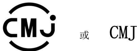
此外，对于设备用绝缘电线的阻燃性检测（F 标记）及耐电压检测（K 标记），可以在电线绝缘上标示如下的标记；也可以用 CMJ 标记代替 F 标记。
