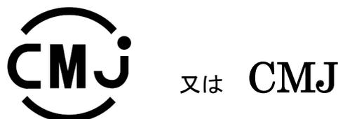
また、機器用被覆電線の難燃性試験 (F マーク) 及び耐電圧試験 (K マーク) については、電線の被覆に次の表示を付すことができますが、F マークの代わりに CMJ マークを付すこともできます。
